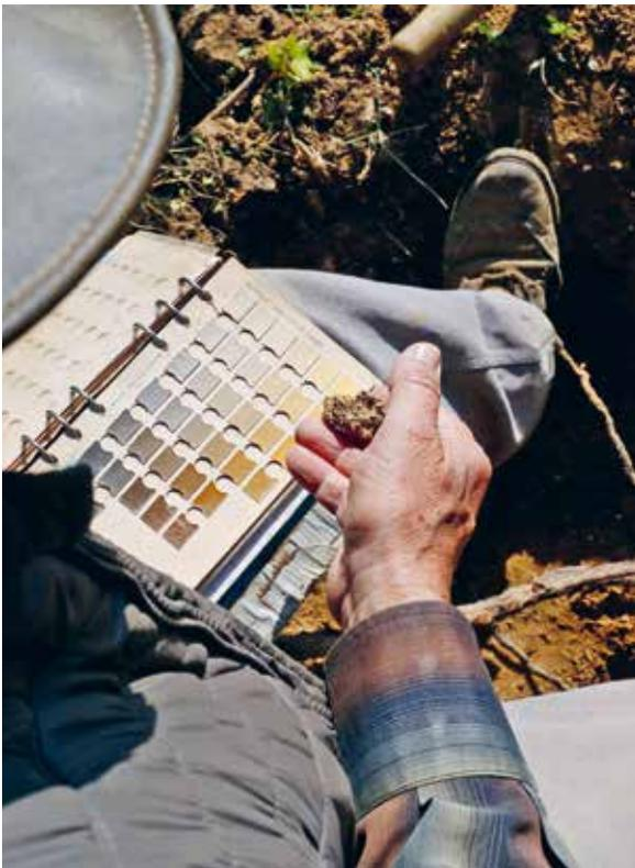
Avec l'aide d'**un réactif**, un premier champ d'analyses permet d'observer l'aération du sol à différentes profondeurs. Un autre test fournira des informations sur la présence plus ou moins importante de calcaire et l'usage d'un **nuancier de couleur** complète cette première observation de sa structure.
