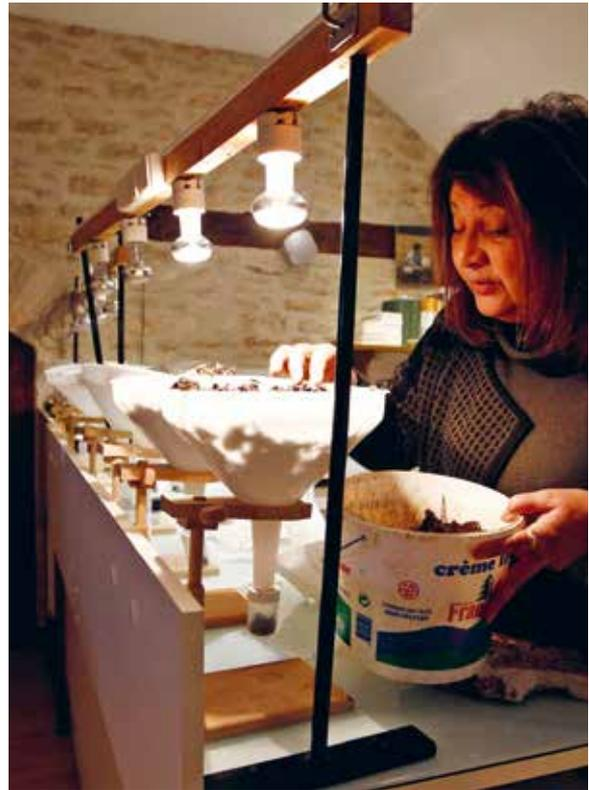
Les prélèvements recueillis sur le terrain sont stockés et analysés rapidement. Une première étape permet de **dénombrer et référencer** certains invertébrés comme les vers de terre, que l'usage de lampes fait remonter à la surface. Au cours des étapes suivantes sont étudiés et comptés d'autres types d'invertébrés, les collemboles par exemple, ainsi que les acariens présents. Les différents types de champignons sont également observés.
